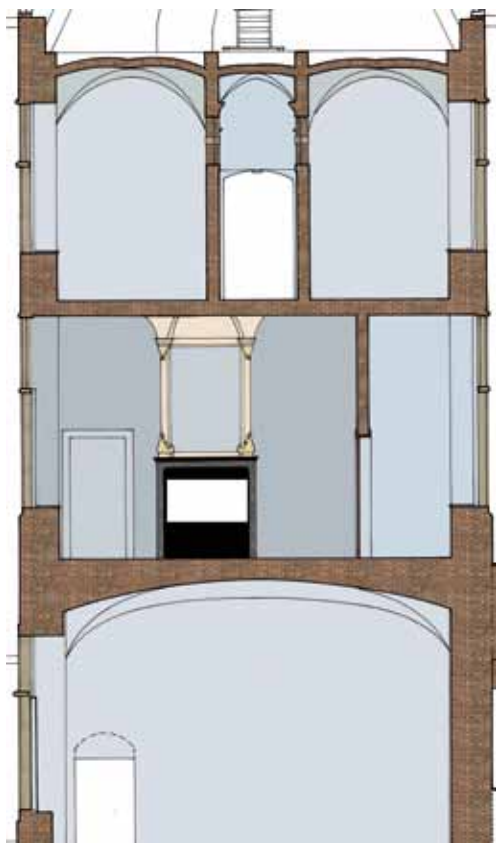
Het is mogelijk geveltekeningen en/of doorsneden met de gevonden NCS-kleuren gelaagd te reconstrueren
