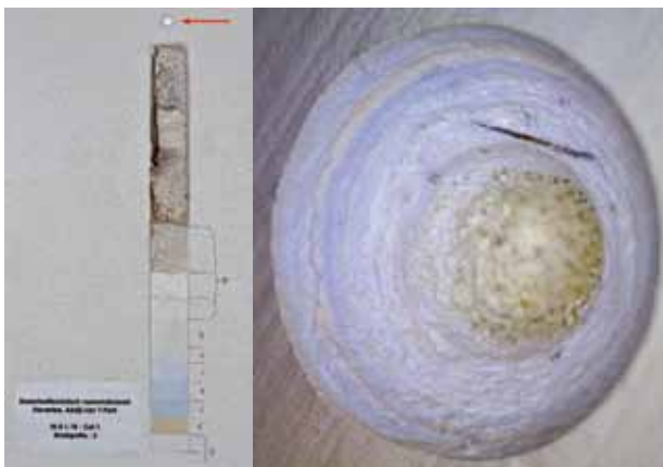
De sondering wordt vergeleken met de referentie-stratigrafie (links), waarvan rechts een microscopische opname (vergroting: 58 x)
