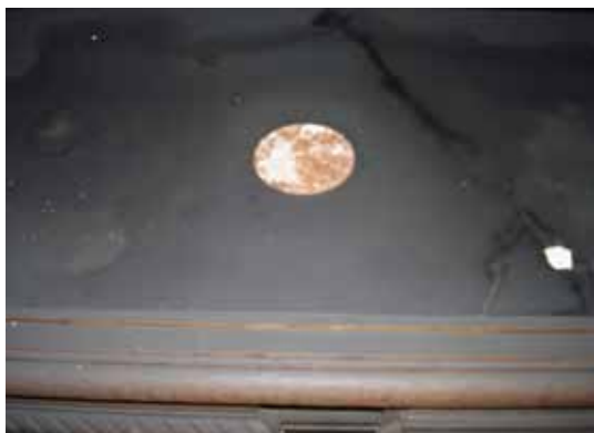
Un objet placé sur cette surface en marbre l'a protégé du dépôt de suies et de son action corrosive. Si les suies ne sont pas éliminées au plus vite, leur action chimique se poursuivra et rendra le nettoyage plus difficile. Il est parfois impossible d'obtenir à nouveau une surface uniforme, le cercle se lira toujours : commode du 18 ème siècle, tablette en marbre rouge, collection privée (photo EN.CO.RE.)
