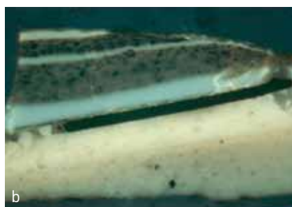
Microphotographie du prélèvement de la couche picturale des toitures (microscope AxioPlan, Zeiss, gr. 160x): a. en lumière normale, b. sous UV, c. en lumière polarisée
