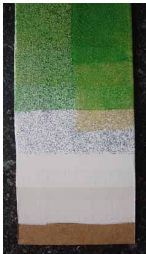
Plaquette de reconstitution du fond aventuriné. À gauche selon la recette de Félix Watin, à droite selon la stratigraphie documentée sur les toitures d'horloges.
