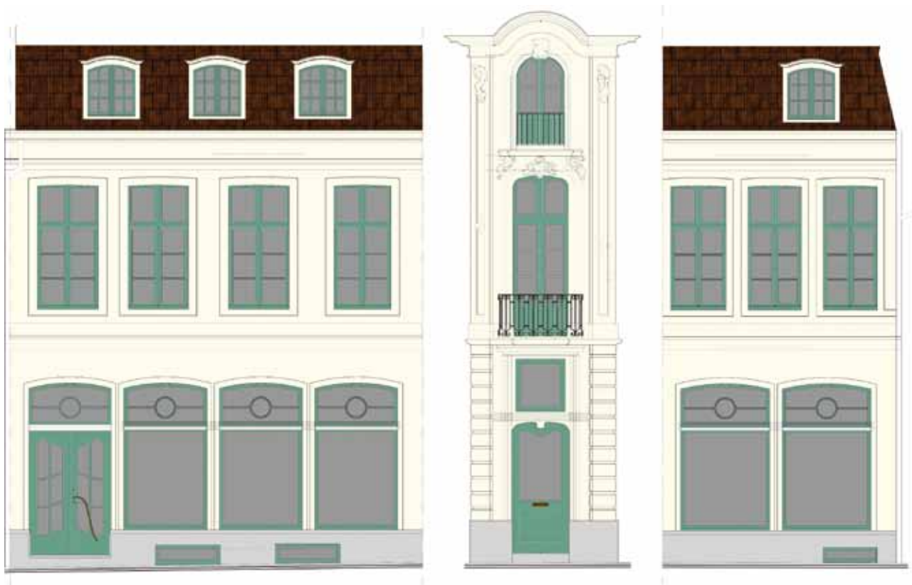
Het is mogelijk geveltekeningen en/of doorsneden met de gevonden NCS-kleuren gelaagd te reconstrueren
