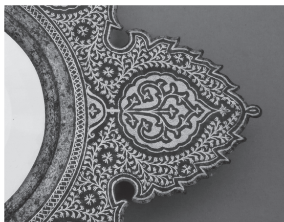
Fig. 4 : De behandeling met de pen-methode heeft de zilver sulfiden weggenomen en de roest van het ijzer ook, zonder de zwarte stabiele patinalaag van het ijzer te beschadigen. Het werd hier gebruik gemaakt van gedemineraliseerd water als elektrolyt.
