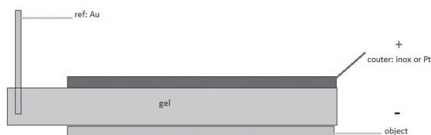
Fig. 5 : Hier wordt er met een potentiostaat gewerkt. Het goud als referentie elektrode, wordt buiten de werkzone geplaatst.
