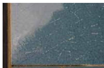
Fig. 15 : Microaltération le long du faïençage / Microverwering aan de craqueleren. (Photo/foto © G. Bussienne)
