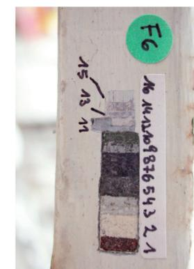
Stratigraphie d'un barreau d'un garde-corps métallique en extérieur.
